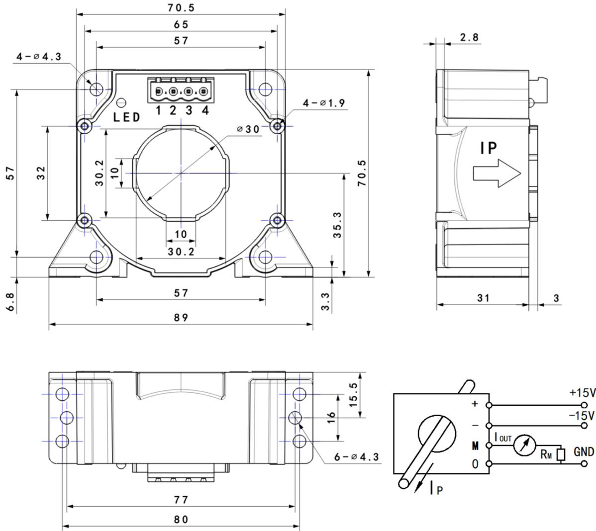
**Pin-Anordnung:**    +: +15V    -: -15V    M: VOUT    O: 0V (Strommasse)
