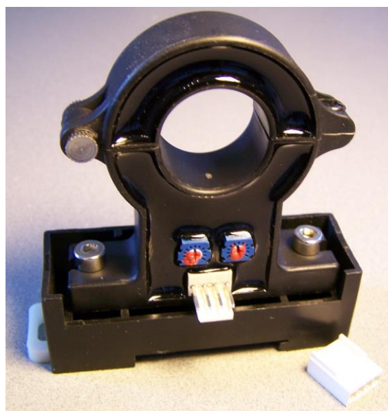
Sensoren mit MOLEX-Stecker (Der Abstand zwischen Boden und Mitte des Loches beträgt 54.8mm)
