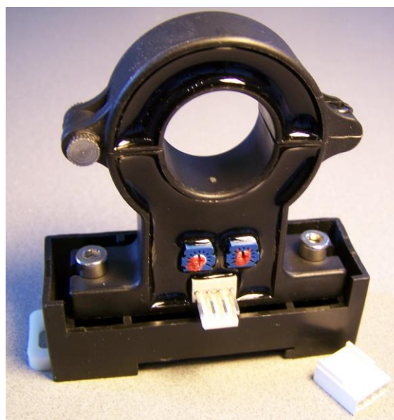
Sensoren mit MOLEX-Verbinder (Der Abstand zwischen Boden und Mitte des Loches beträgt 54.8mm)
