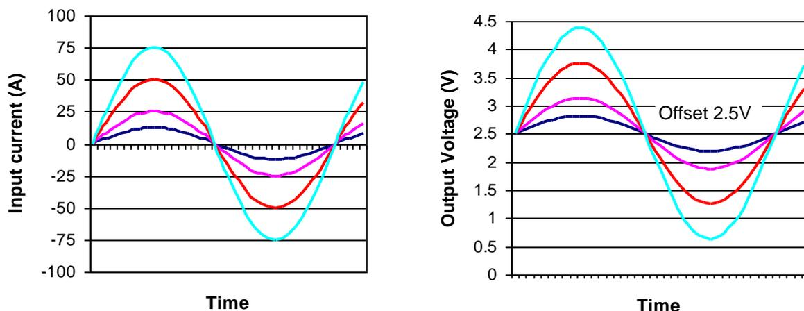
**Bild. 2** Beziehung zwischen Eingangsstrom (AC) und Ausgangsspannung (AC)
