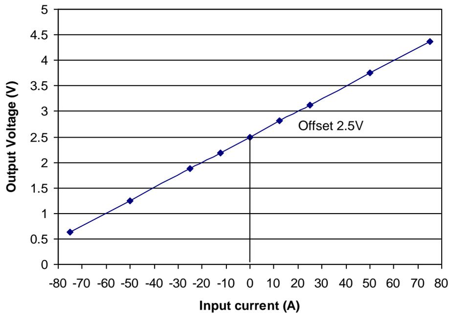
**Bild. 1** Beziehung zwischen Eingangsstrom (DC) und Ausgangsspannung (DC)
