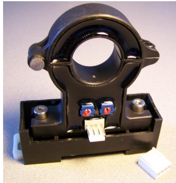
Sensor mit MOLEX-Stecker (Der Abstand zwischen Boden und dem Lochmittelpunkt beträgt 54.8mm)
