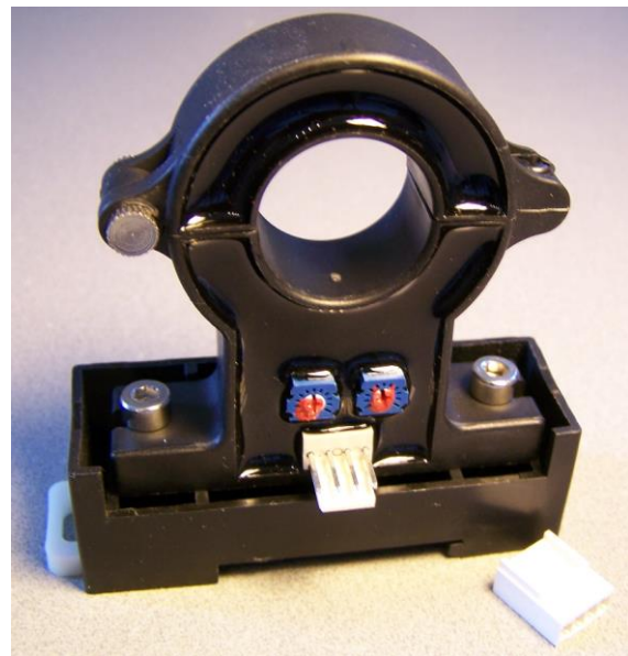
Sensor mit Molex Stecker (Der Abstand zwischen Boden und der Mitte des Loches beträgt 54.8 mm)
