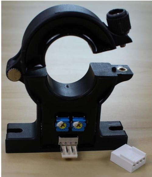
Sensor mit Molex-Stecker (Der Abstand zwischen Boden und der Mitte des Loches beträgt 54.8 mm)
