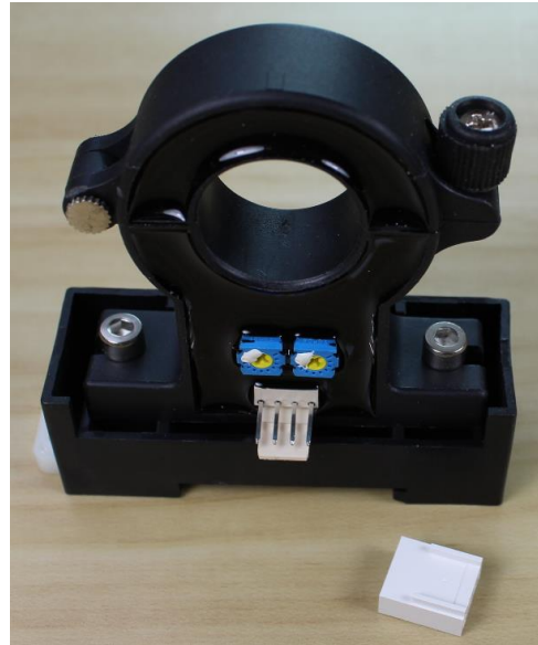
Sensor mit Molex-Stecker (Der Abstand zwischen Boden und der Mitte des Loches beträgt 54.8 mm)
