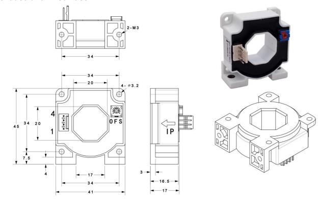
**Pin-Anordnung:** 1: +15V 2:-15V 3: V<sub>OUT</sub> 4: 0V (Erdung) OFS: Nullpunkteinstellung
