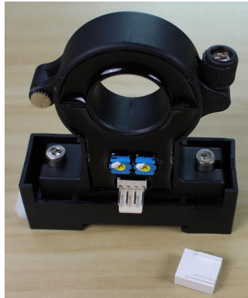
带莫仕连接件的传感器 (从底部到孔中心的距离是 54.8mm)
