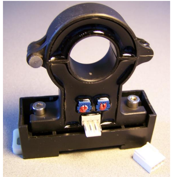
带 Molex 连接器的传感器 (从底部到孔中心的距离是 54.8mm)
