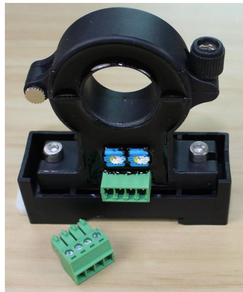
带 Phoenix 连接器的传感器 (从底部到孔中心的距离是 54.8mm)
