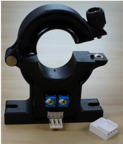
带 Molex 连接器的传感器 (从底部到孔中心的距离是 54.8mm)
